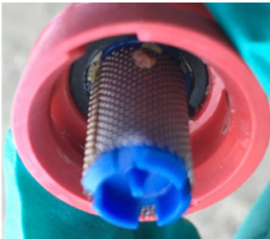
Résidus de produits récupérés au niveau des filtres buses après utilisation d'un nettoyant
