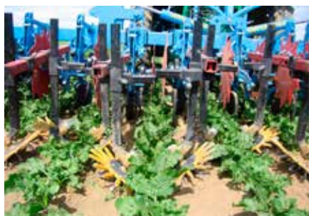
Bineuse avec moulinets 8-10 km/h
